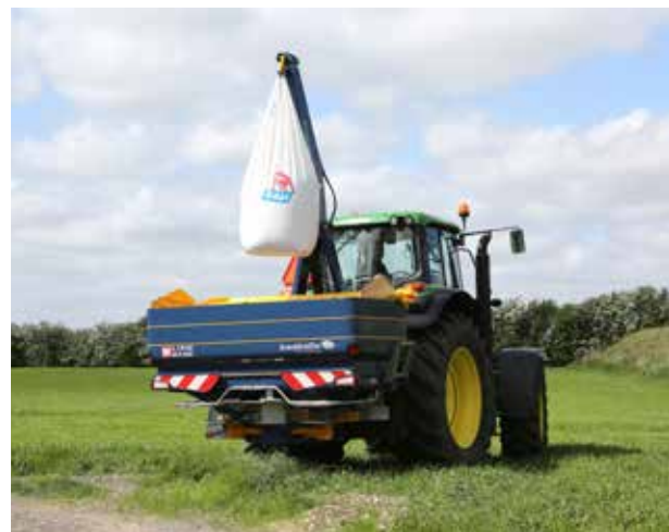
BXL 1300モデルは1300 Kgの重量まで持ち上げることができ、容量3300ℓまでのスプレッターに取り付けることができます。
