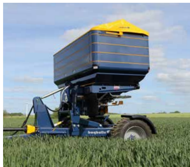
スプレッターを外して、丈のある作物の頭頂部への後散布に使用することができます。
