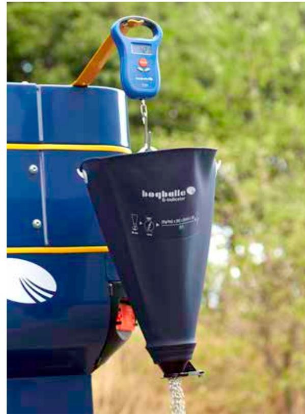
Sインジケータは操作が易しく、特定の肥料の完全なフローテストが数分で行えます。
