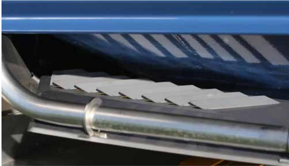
散布ディスクの回転によりガードの穴から制御された気流が出て、肥料を散布ディスク上に均等に載せます (Mライン)。
