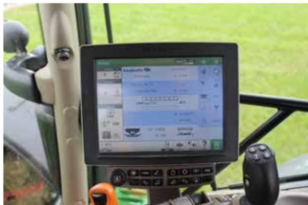
速度独立のスプレッダーでは、PTO回転数が直接ディスプレイ上でモニターされます。
