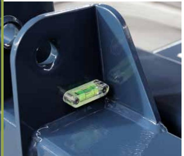
トップリンクの水準器は、散布ディスクに平行に固定され、スプレッダーの作業角度を正しく設定するための参照ポイントとなります (MラインおよびL20(W))。
