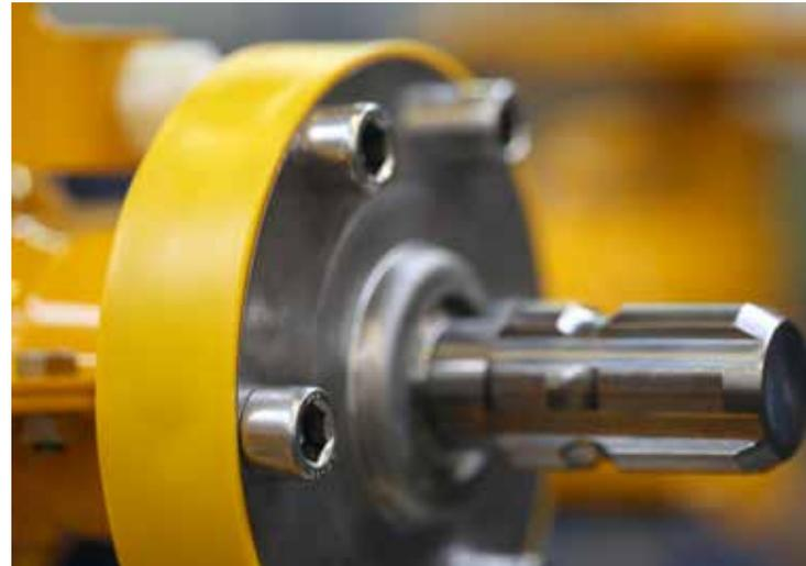
耐水性メンテナンスフリーのオーバーロードクラッチは、トラクターの高速回転時のPTO始動の場合に、トラクター、PTOシャフトとトランスミッションの破損を防ぎます。
