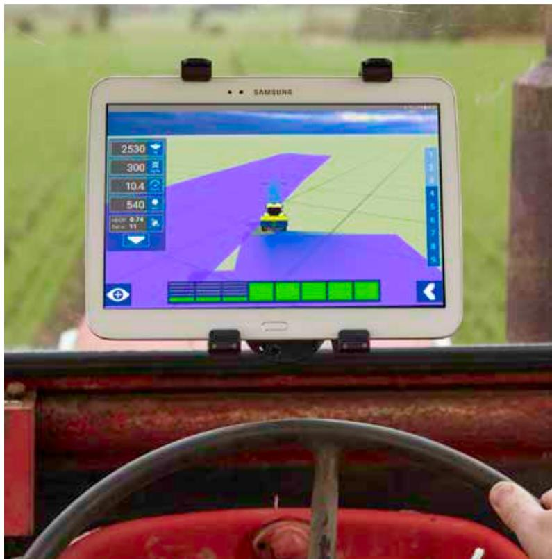
GPS経由での完全自動セクションコントロールと可変レートアプリケーションには、アンドロイドタブレットを使用してください。農場の最も古いトラクターでさえ最新のGPSテクノロジーにアップグレードすることができます。
