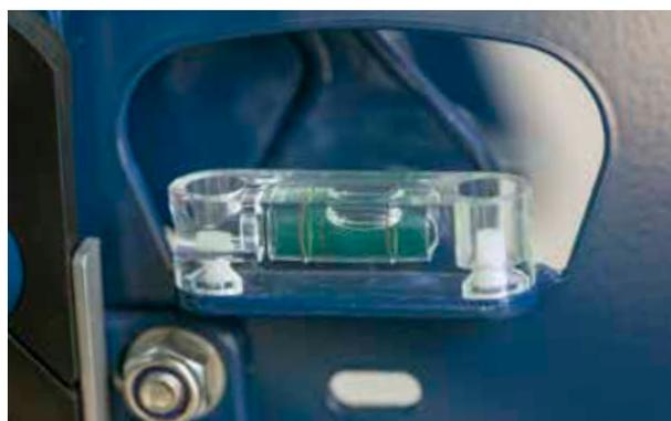
L15のスプレッダーでは常に、水平の位置にセットされています。正しく取り付けられるよう、トップリンクの位置に固定水準器がついています。
