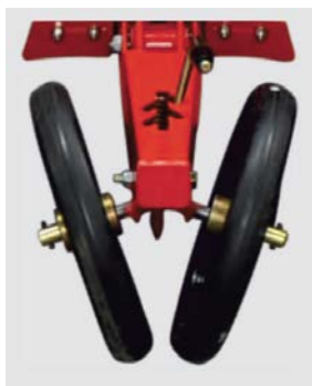
V字リアローラーは、種子床を押しつけて閉じます。
