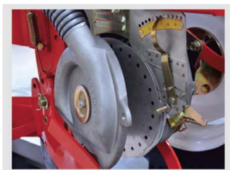
外部レバー付きディストリビューションボックスは、穴に2個入った種子を取り除きながら、セレクションチャンバーでの種子の供給を調整します。
